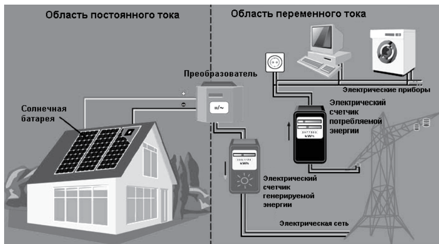
Рисунок 4.9. Принцип подключения солнечных батарей к электрическим сетям
