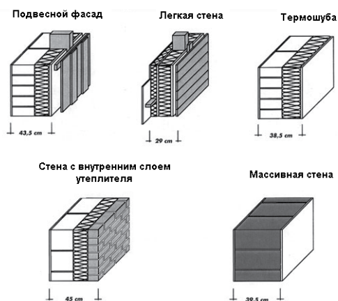
Рисунок 2.6. Схемы конструкций стен с увеличенным теплосопротивлением
