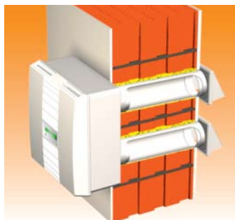
Рисунок 2.33. Вид децентрализованного устройства для обеспечения воздухообмена с рекуперацией тепла
