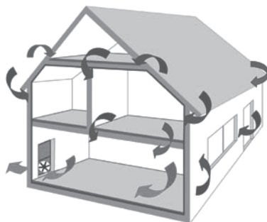
Рисунок 2.22. Вид смонтированной установки для оценки степени герметизации зданий и фото, показывающее высокую диффузию наружного воздуха через электрические розетки
