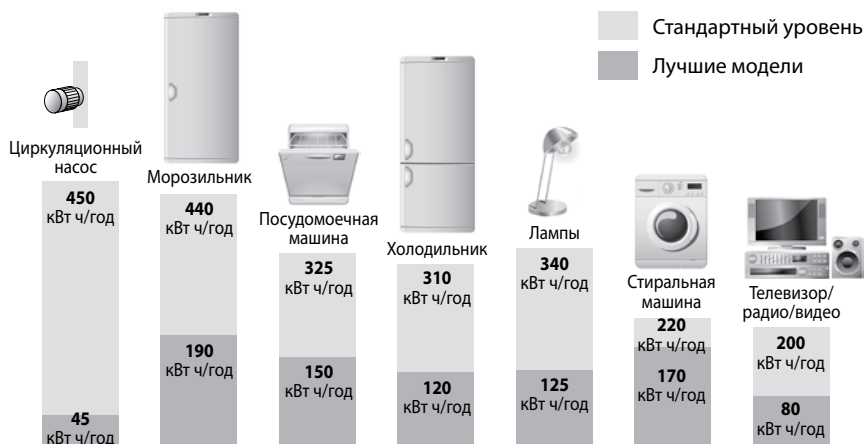
Рисунок 3.9. Сравнительная характеристика энергопотребления циркуляционных насосов и бытовых электроприборов
