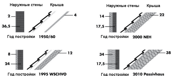
Рисунок 2.4. Требования к теплоизолирующему эффекту ограждающих конструкций зданий в Германии для домов различных лет постройки
