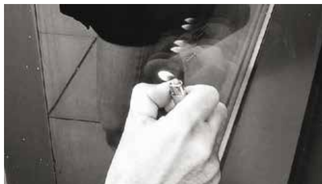
Рисунок 5. Простой способ убедиться, есть ли на стекле защитное покрытие: в таком случае отражение пламени будет темнее и с красным оттенком.
