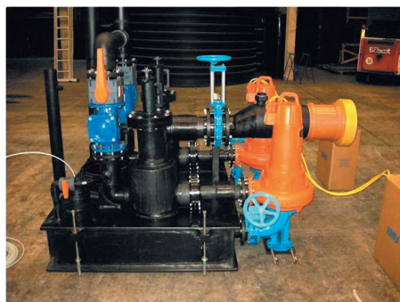
Рис. 1.9. Вид смонтированного оборудования насосной станции с разделением примесей.
