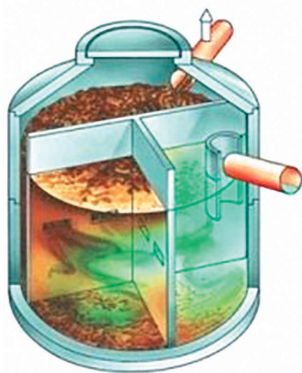
Рис. 2.19. Вид установки для очистки сточных вод с удалением органических веществ.
