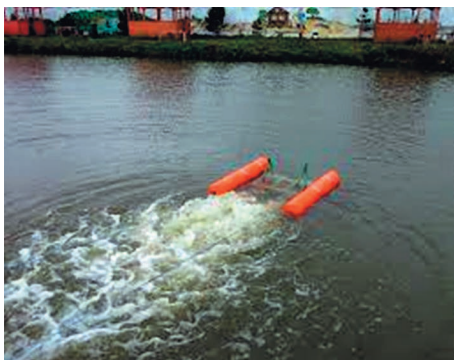
Рис. 2.2. Биологические пруды с искусственной аэрацией.
